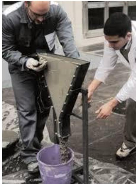
Ensayo del embudo en V
