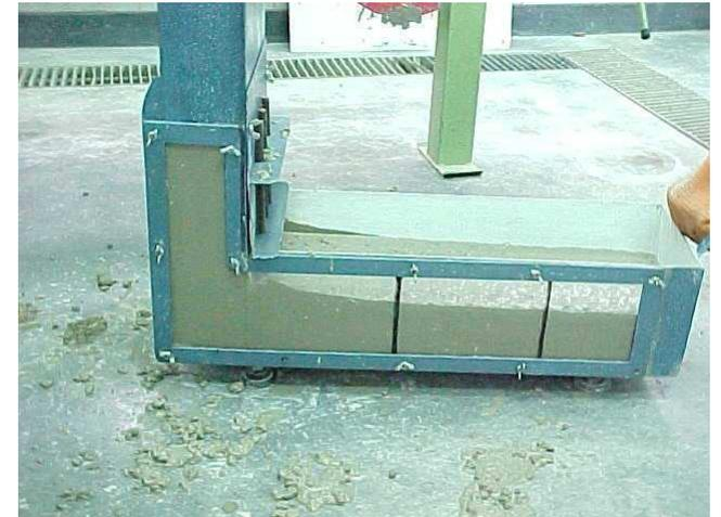
Ensayo de la caja en L
