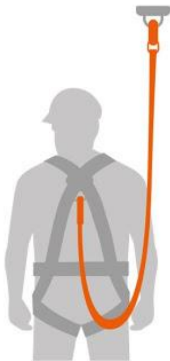
Sistema de conexión
