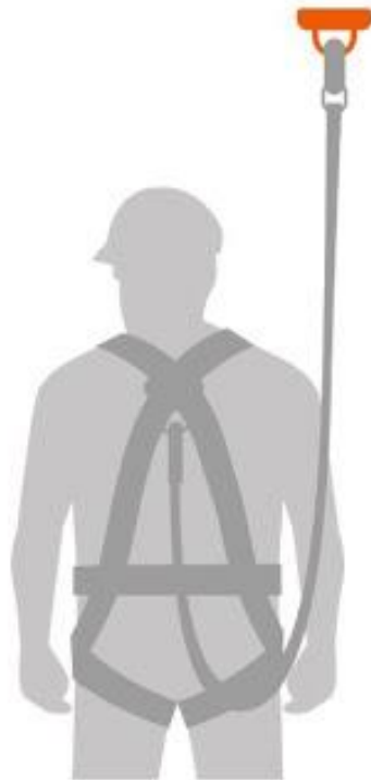
Sistema de anclaje.
