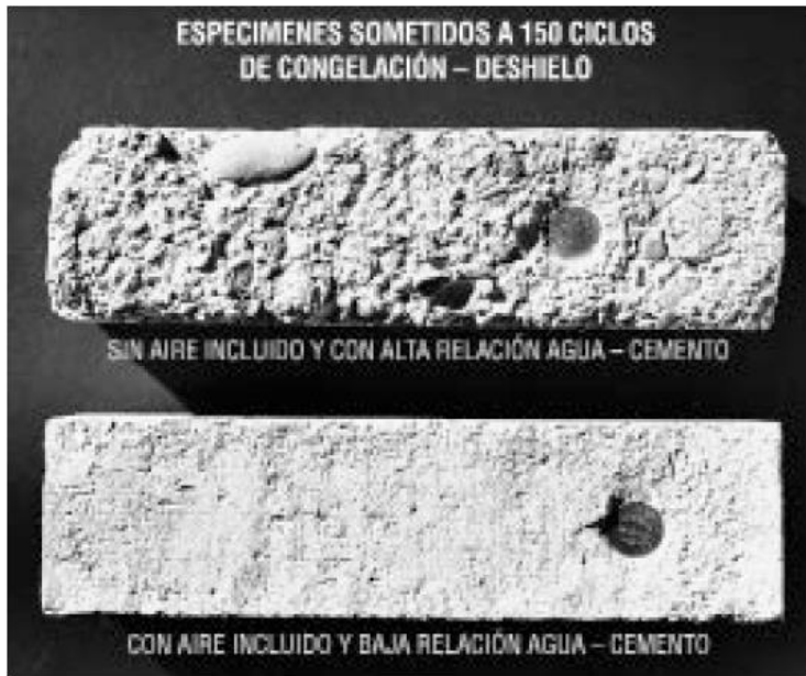
Fig. 1-25. El concreto con aire incluido (barra de abajo) es muy resistente a ciclos repetidos de congelamiento y deshielo. (P25542)
